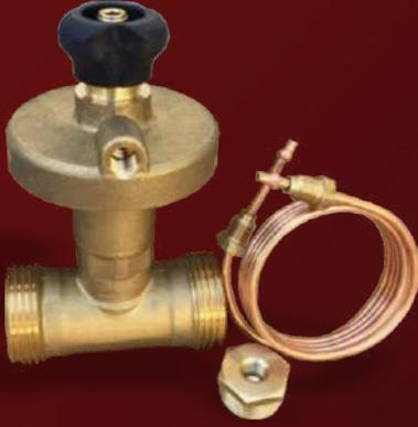
Fark basınç kontrol vanası, hidrolik devrenin iki noktası arasındaki basınç farkını her zaman ayarlanmış değerde tutar. Cihaz devrenin dönüş borusuna yerleştirilir ve kapiler boruyla gidiş borusu üzerindeki vanaya bağlanır. Daha sonra tüm debiyi düzenlemek için kullanılabilir. Komple veya kısmi kapamalardan dolayı oluşan fark basınç artışını sınırlamak için, farklı debilere sahip iki yönlü termostatik veya motor vanalı sistemlerde kullanılabilir.
